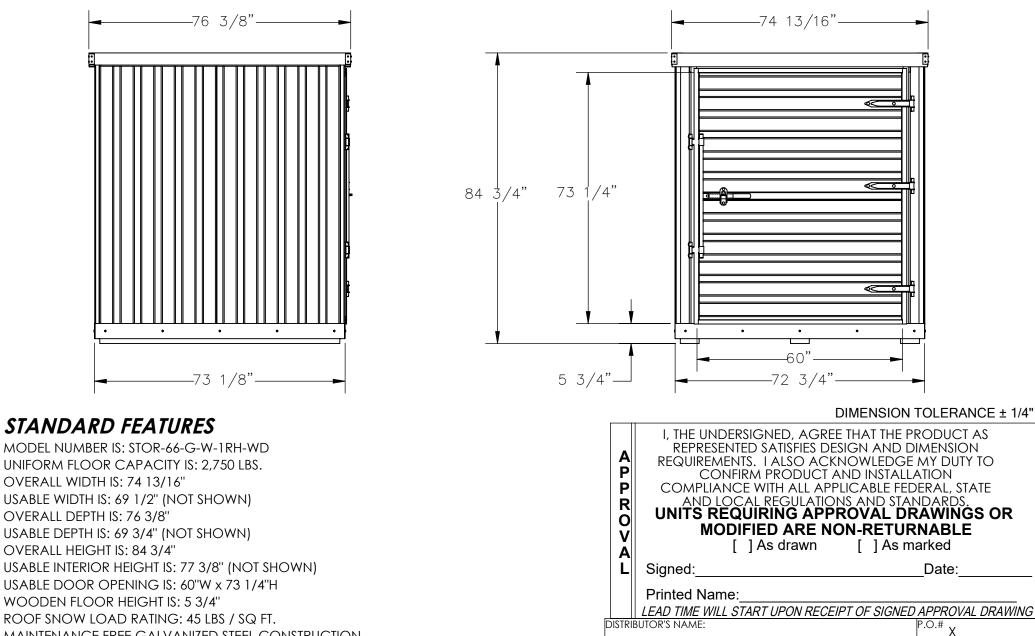
MAINTENANCE FREE GALVANIZED STEEL CONSTRUCTION
